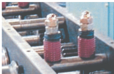
Натяжное устройство с автоподстройкой для полного диапазона толщин материала
