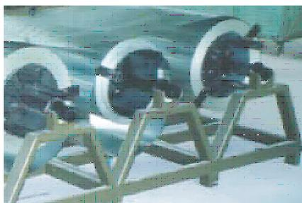
Автоматизированная линия **Cut-To-Length HVAC** предоставляет Вам простое и экономичное решение для производства прямых участков воздуховодов прямоугольного сечения из материала толщиной 1.6 мм/16 калибр (низкоуглеродистая сталь) и шириной 1524 мм (возможна поставка модели 1829 мм) со скоростью подачи материала 18.2 м/мин и точностью +/-0.5 мм.
