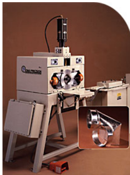
Станок для производства и сборки фитингов Collar-Matic
