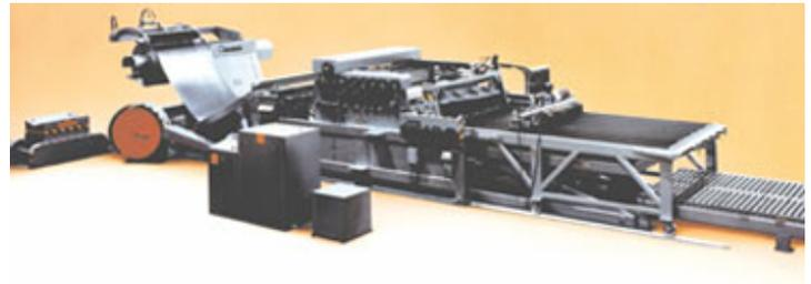
Электронный контроллер **Slear-2** обеспечивает удобство и лёгкость задания размеров и счёта продукции. Линия поставляется с широким набором дополнительных приставок и дополнительных узлов, включая устройства для подрезки и подмотки края материала, оборудование для нарезки отходов, и разнообразные системы укладки заготовок.
