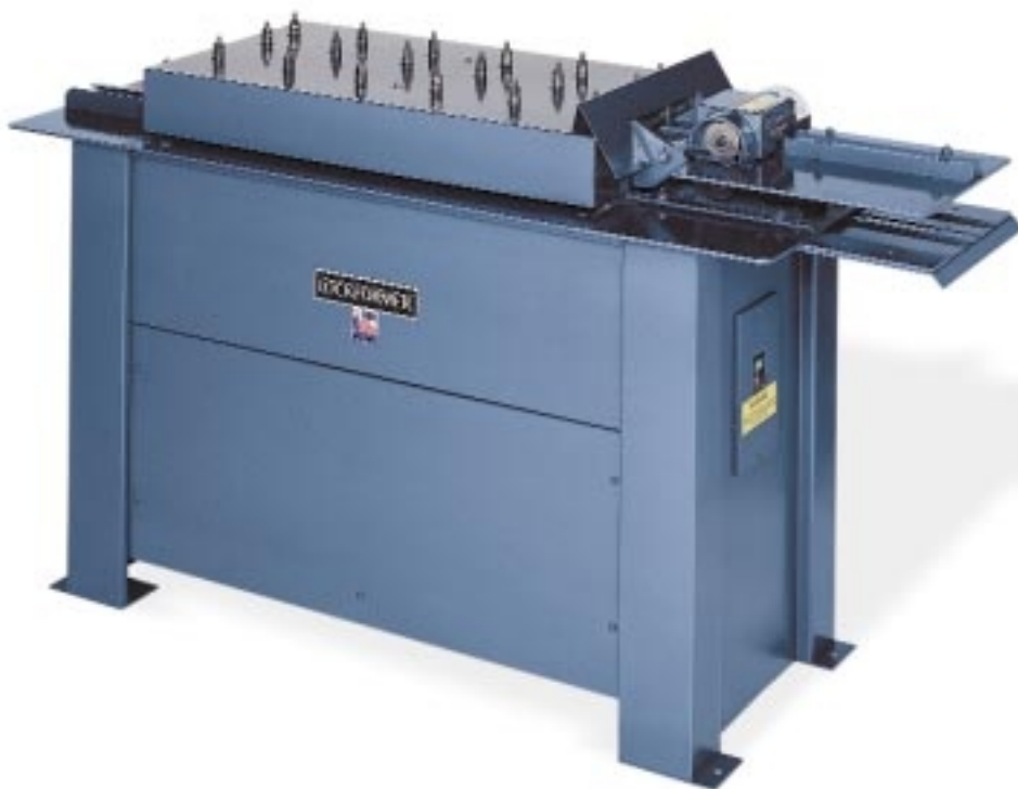
Дополнительная приставка для отрезания отходов при изготовлении С-образных и S-образных реек (шин)
