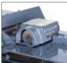
Дополнительная приставка для отрезания отходов при изготовлении С-образных и S-образных реек (шин)
