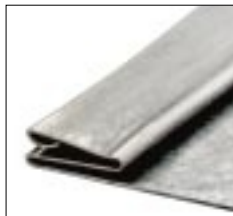
Профиль, изготовленный на внутренних роликах
