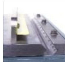
От проштампованных Snap Lock замков до Pittsburgh замков – просто отвинтите три болта и переверните гибочный штамп
