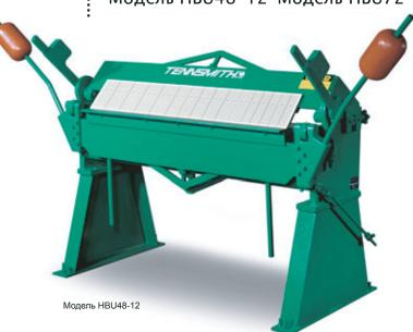
Этот станок для гибки оснащён сменной вставкой для гибочного фартука, позволяющей формировать изгибы радиусом 6.4 мм из тонкого материала. Регулировочные винты верхней гибочной кромки оснащены упорными подшипниками, предотвращающими её сползание. Стальные ручки зажимов, тяжёлые противовесы и стопор фартука делают этот станок ещё более удобным в использовании. Сменные вкладыши закалены цементацией для надёжной и продолжительной службы.
